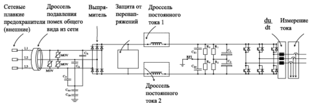
Рис. 4.16. Преобразователи частоты и меры подавления ВЧ-помех
