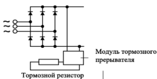
Рис. 3.19. Включение тормозного модуля и тормозного резистора
