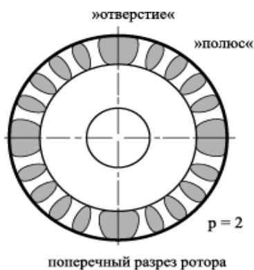
Рис. 1.38а Ротор реактивного электродвигателя
